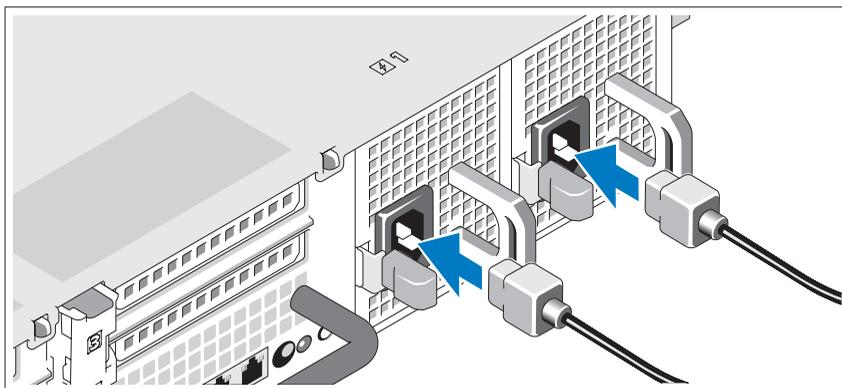
Conecte o(s) cabo(s) de alimentação ao sistema e, se for usado um monitor, conecte o cabo de alimentação ao monitor.
