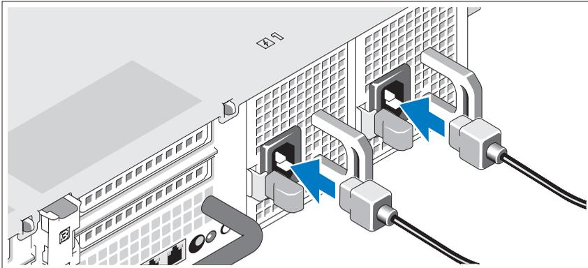
Conecte los cables de alimentación al sistema y, si se utiliza un monitor, conecte el cable de alimentación al monitor.
