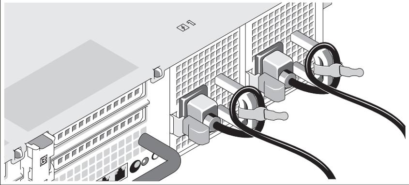
Dobre o cabo de alimentação do sistema em forma de laço conforme a ilustração e prenda-o com a tira fornecida.
